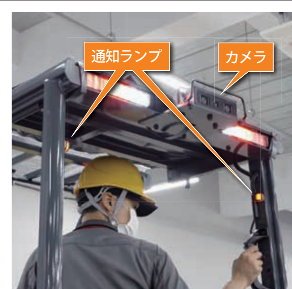
②車両後方に取り付けられたフォークリフト専用設計のカメラが、検知エリア内の障害物の中から人と物を見つけて、通知ブザーと4つの通知ランプでフォークリフトオペレーターに接近をお知らせ。
