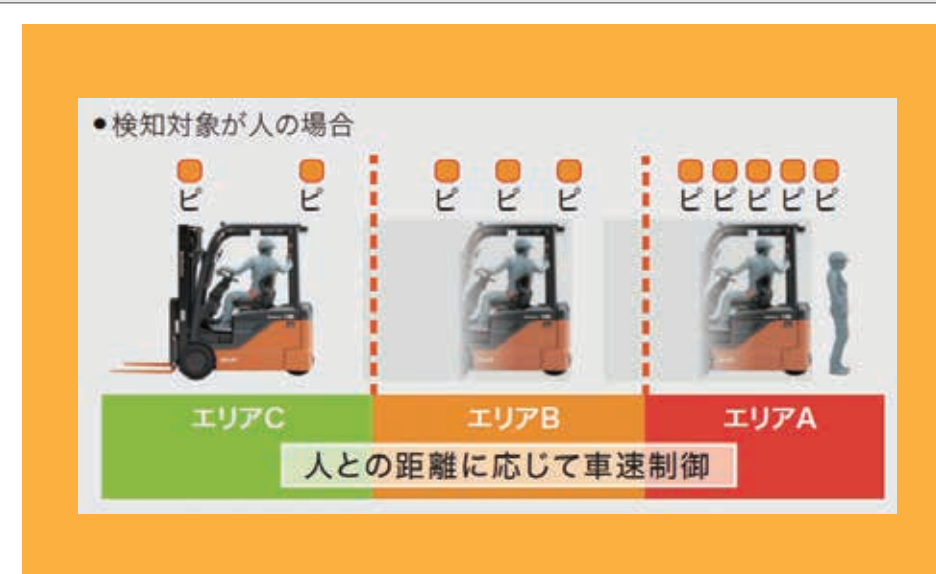
②車両後方に取り付けられたフォークリフト専用設計のカメラが、検知エリア内の障害物の中から人と物を見つけて、通知ブザーと4つの通知ランプでフォークリフトオペレーターに接近をお知らせ。
