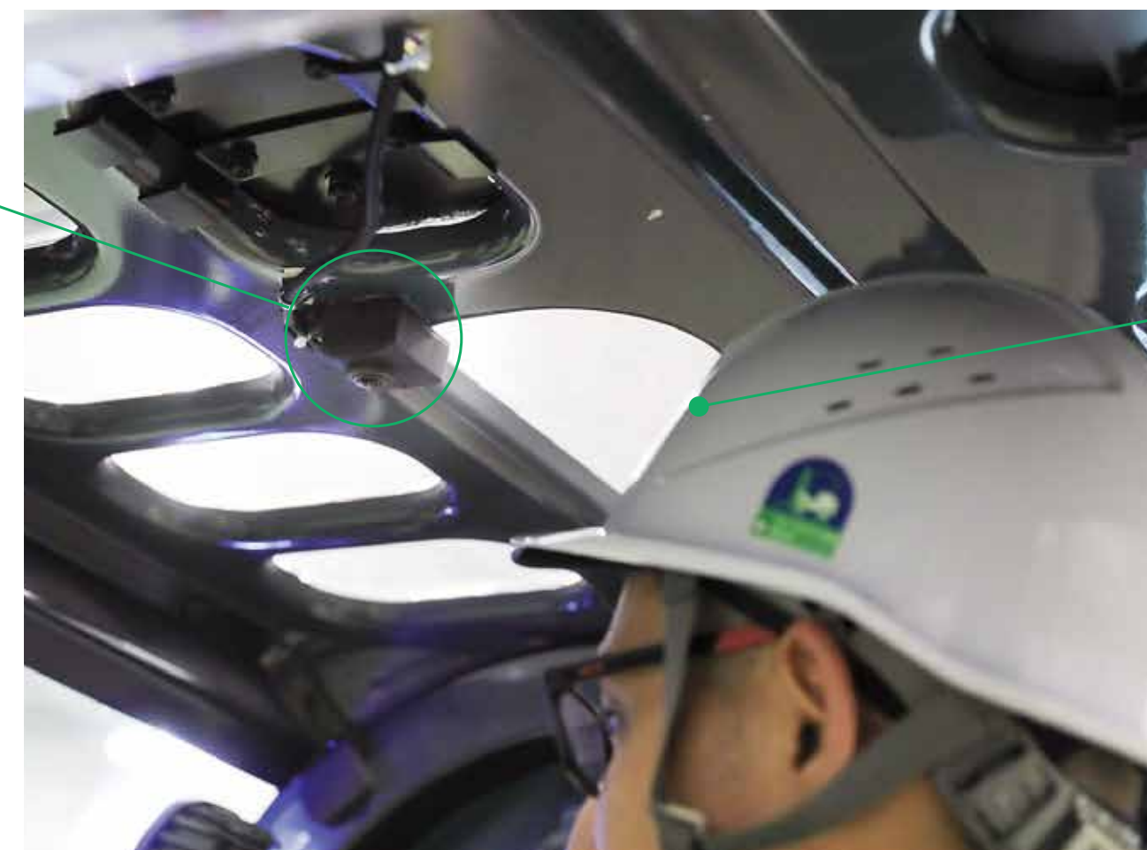
識別用ARマーカをヘルメットなどに貼り付ければ、映像からオペレーターを自動識別。
