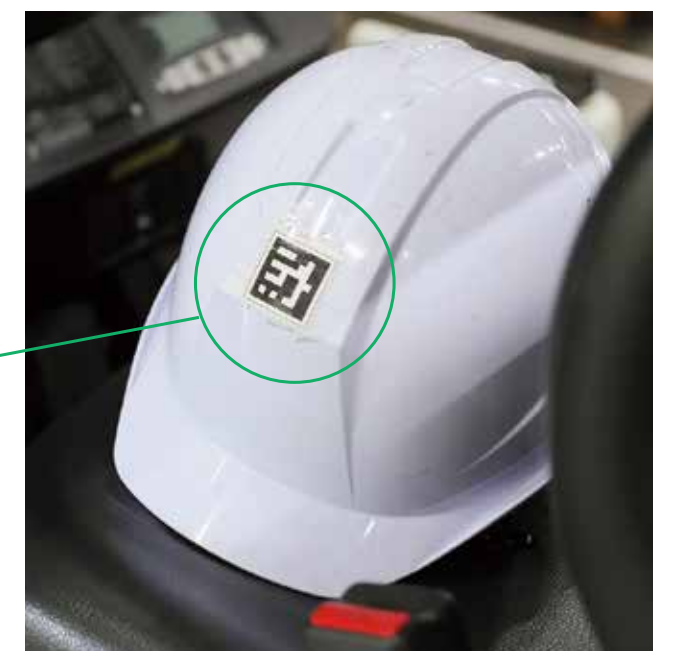
識別用ARマーカをヘルメットなどに貼り付ければ、映像からオペレーターを自動識別。
