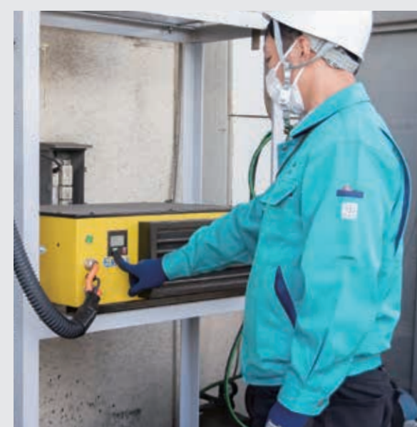
④準備完了後、充電ボタンを押して、充電開始。
