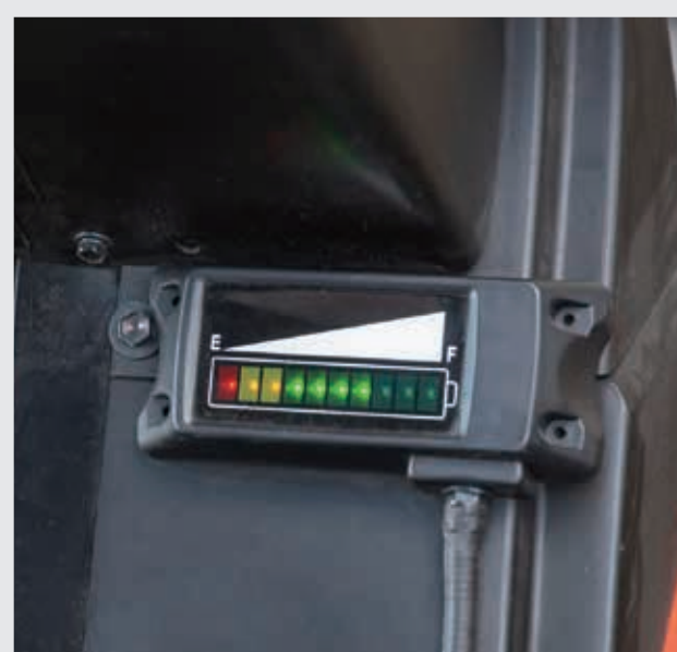
①車両に設置された、専用容量計で充電量をチェック。
