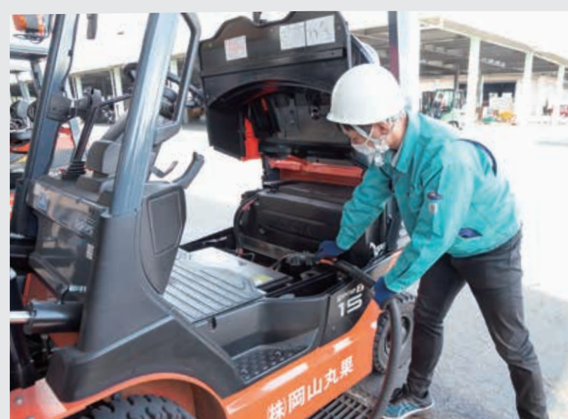
③充電の準備はENELORE®本体に専用コードを接続するだけで完了。
