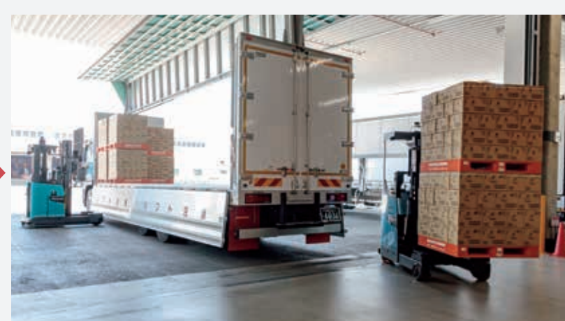
2台の自動運転フォークリフトが連動して トラックへ積み付け。
