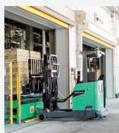
2パレットずつ出庫された 商品を自動運転フォーク リフトが荷取り。
