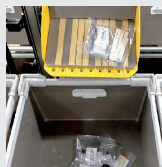
③仕分け t-Sort3Dのフラップが指定のバケットに移動し、商品を自動仕分け。
