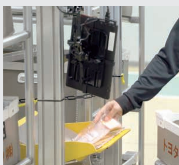
②商品投入 作業者がピッキングされた商品のバーコードをスキャンし投入。
