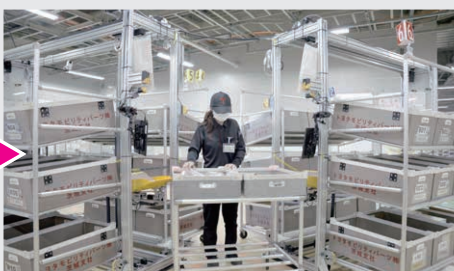
①ピッキング 出庫指示に従い作業者がピッキングした対象商品を台車でt-Sort 3Dまで搬送。
