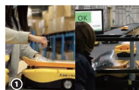
① 商品をスキャンし、ロボットに投入
