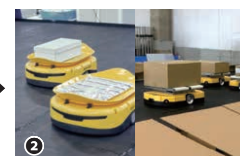
② WCSの情報を元に、ロボットが自動で各シュートへ搬送
