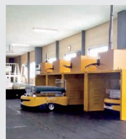
④自動充電ステーション 各面に4台の充電ステーションを設置。ロボットは充電が少なくなると、充電ステーションまで自動走行して充電を行うため、連続稼働が可能。
