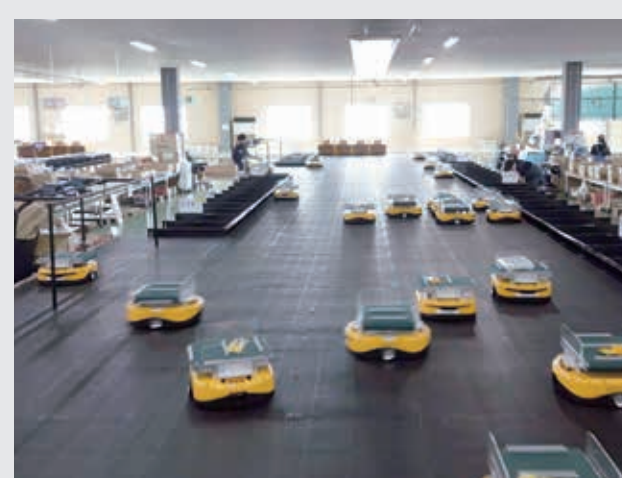
②自動搬送 WMSの情報を元にロボットが商品を自動搬送。
