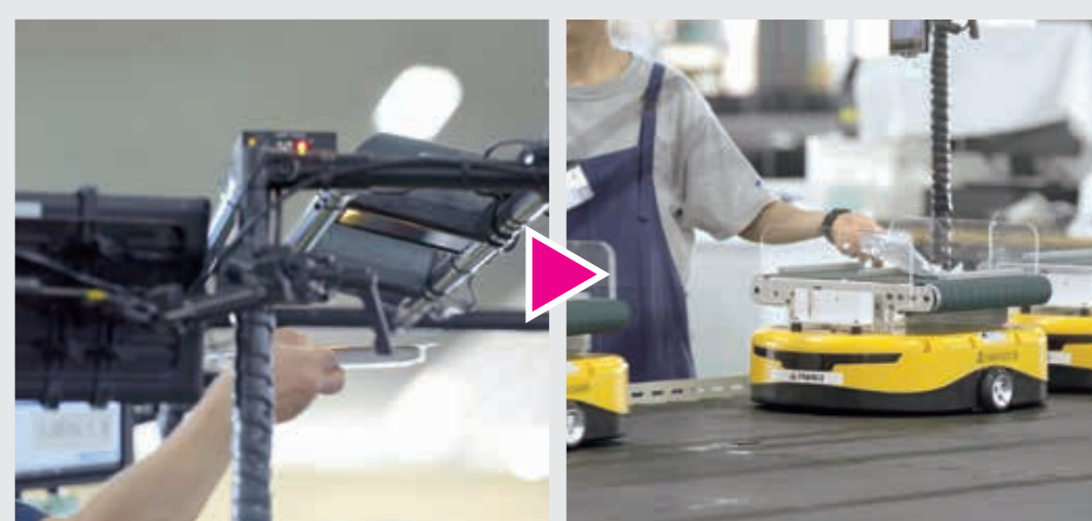
①商品投入 作業者がスキャナで商品JANコードを読み取り、ロボット上に商品を投入。
