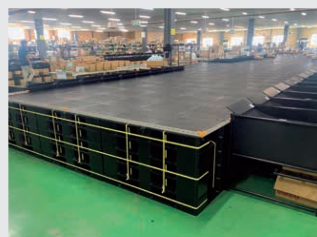
〔走行エリア〕 約150㎡の走行エリアを2面導入。パレットを積んで製作した架台上にPVCシートを設置。
