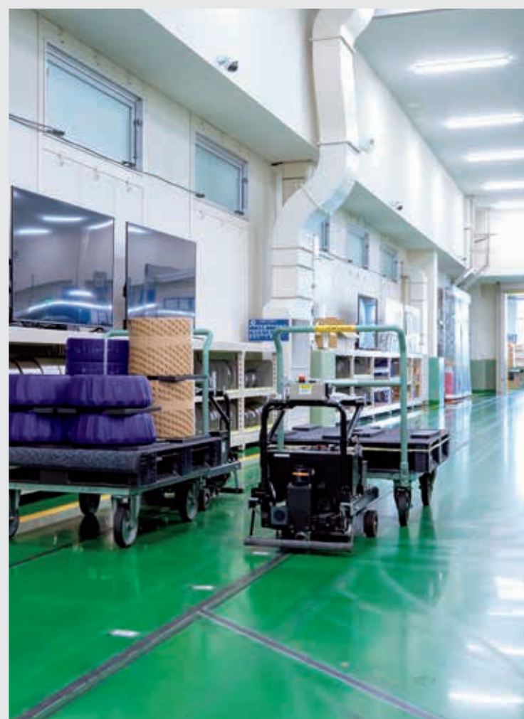
⑤ 工程間搬送 部品供給や空パレット搬送などは、トヨタL&Fのキーカートを使用して自動搬送。
