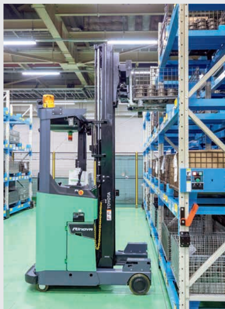
② 入庫 供給完了ボタンを押すと、AGFが荷取りし、移動ラックと連動し自動でパレットを入庫。
