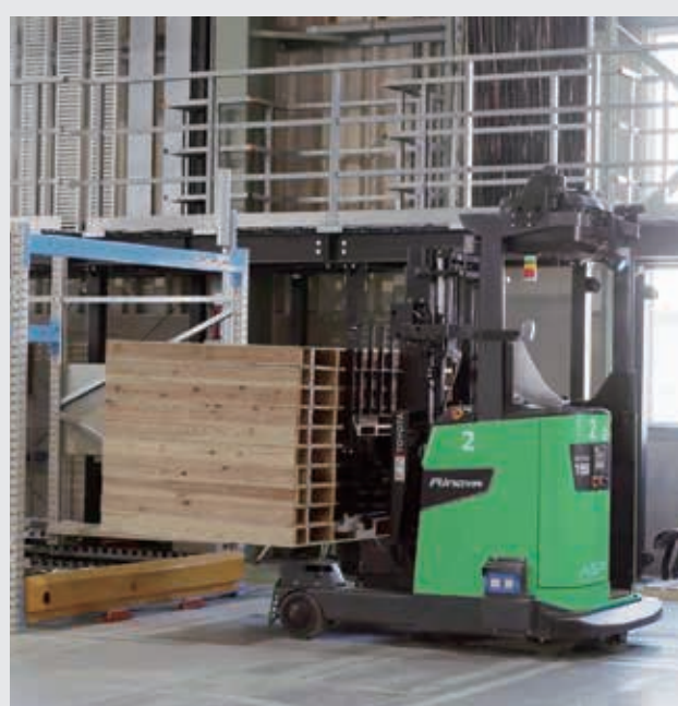
①空パレットの搬送 完成した棚板を積み込むための空パレットをピックアップし、棚板生産ラインへ自動搬送。
