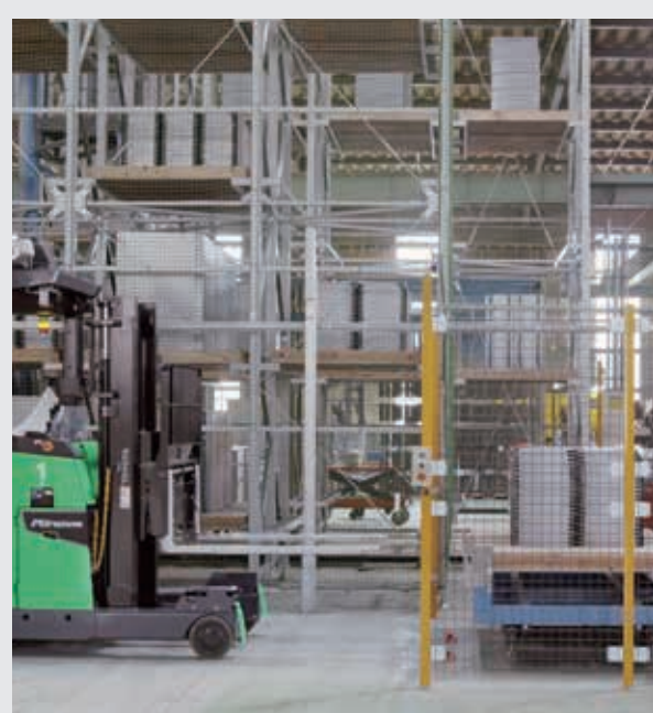
④自動倉庫から出庫 次工程の塗装ラインの準備が整うと、自動倉庫から再出庫された棚板を荷取り。
