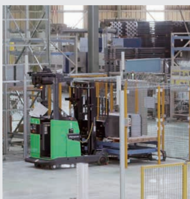
③自動倉庫へ搬送・入庫 4本の生産ラインから荷取りした棚板を自動倉庫へ搬送・一時入庫。
