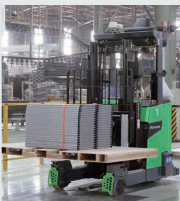
②棚板生産ラインから荷取り 4本の生産ラインから完成した棚板を順次荷取り。
