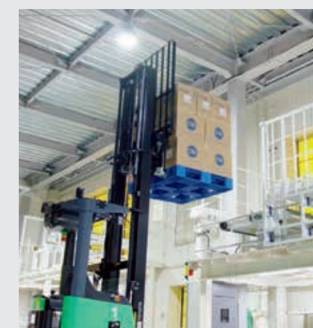
④-3 自動搬送 自動搬送コースポイントに到着すると、生産ラインへのコンベヤに資材を供給。
