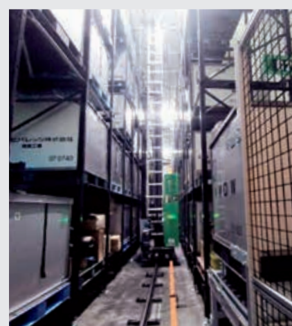
②保管 2基のパレット用自動倉庫で資材を保管。総保管間口は321間口。
