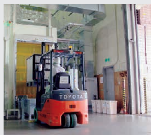
①入庫 有人フォークリフトで自動倉庫に資材を入庫。
