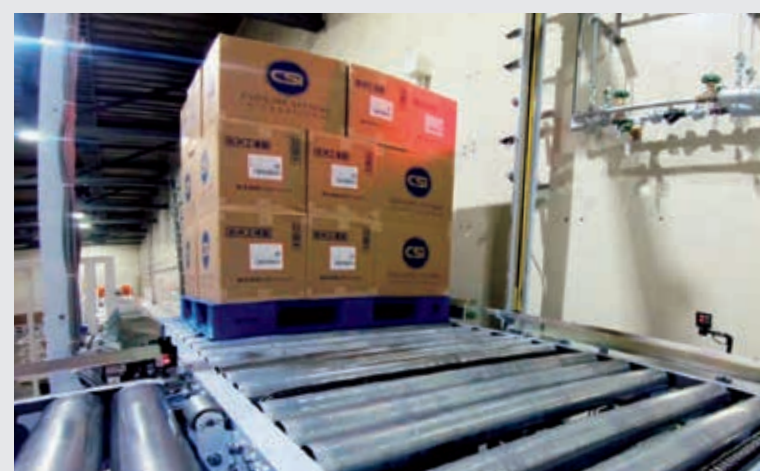
③出庫 生産品目を選ぶと、使用する資材が全自動で出庫。自動倉庫の前後にバーコードリーダーを設置。管理システムを構築することで、使用した資材のトレーサビリティも確保。
