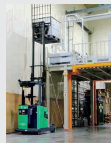
④-1 自動搬送 高さ約4mの架台上から資材パレットを受け取り。
