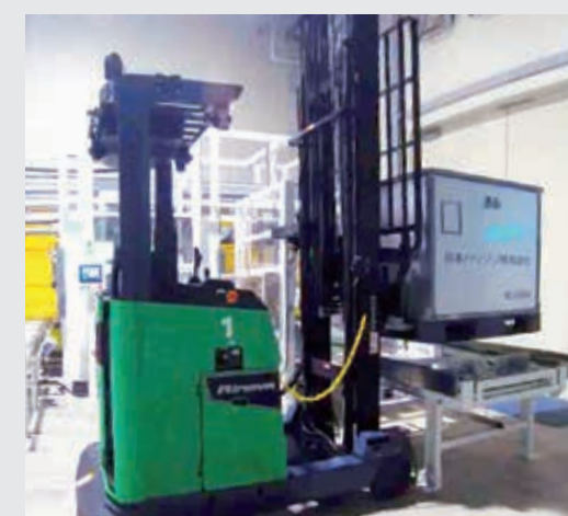
④-4 自動搬送 供給後の空パレットや空コンテナもユースポイントの別コンベヤよりAGFが受け取り、自動倉庫へ搬送。
