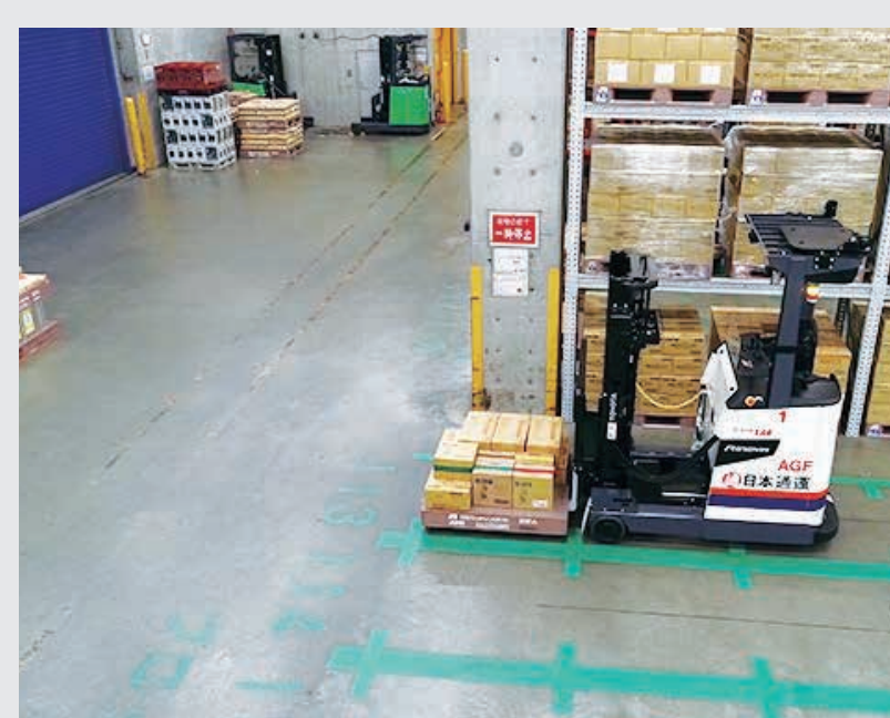
④仮置き 受け取った出荷パレットは出荷待機場まで自動搬送。
