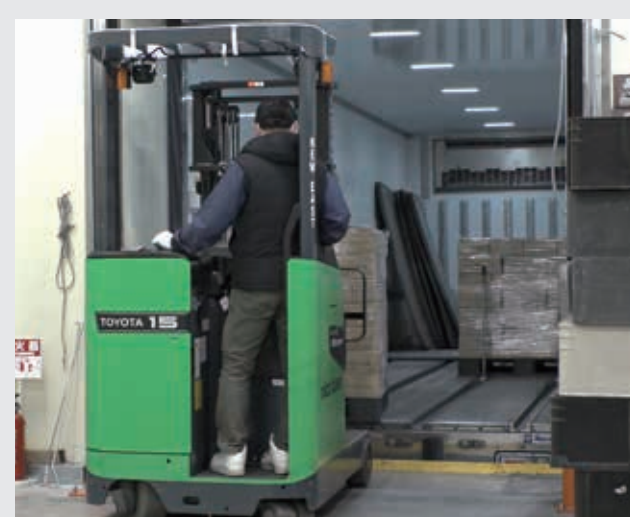
⑤出庫 有人フォークリフトにて、トラックへ積み込み。 [ポイント]入荷・入庫・出庫・出荷全ての工程をトラック運転手1人で行うことが可能な「ワンオペ」運用を実現。作業者が冷凍庫内に入らずに入出庫作業が可能です。
