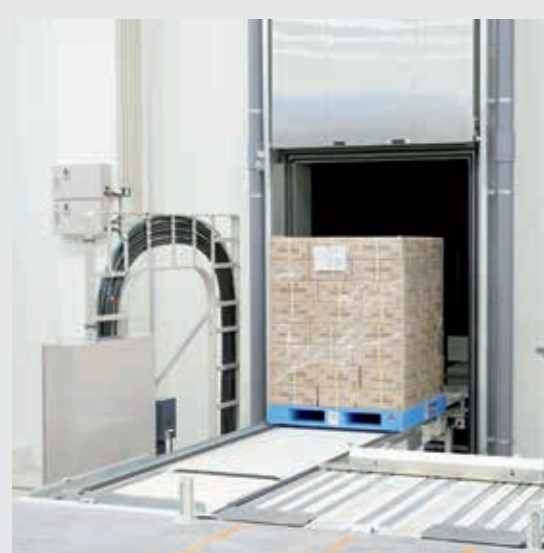
④-1出庫 既存の上位WMSと連携した倉庫制御システムIS-200の指示により、商品が自動で倉庫から出庫。
