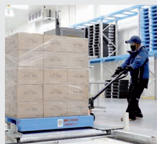
④-2出庫 出庫された商品は、ハンドパレットで取り出し、出荷エリアに搬送。
