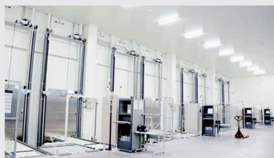
①入出庫作業エリア 入出庫作業エリア(チルド帯 0\sim 5^{\circ}\text{C} )と保管エリア(冷凍倉庫 -25^{\circ}\text{C} )に分かれており、人手作業は入出庫作業エリアのみで完結。
