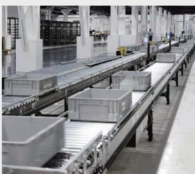
⑤ケースコンベヤライン
