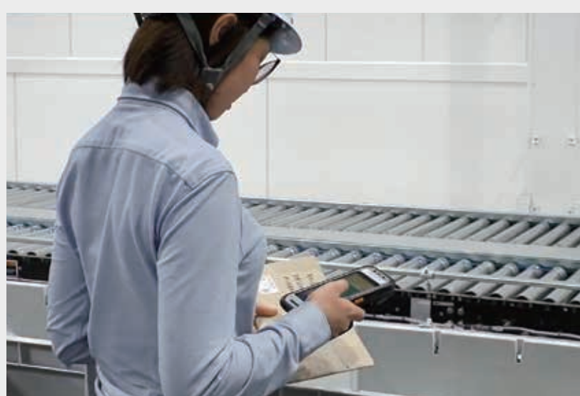
⑥入庫・出庫ステーション 入出荷量の変動に柔軟に対応できるように、6ヵ所のコンベヤライン入出庫口をすべて入庫にも出庫にも変更可能。
