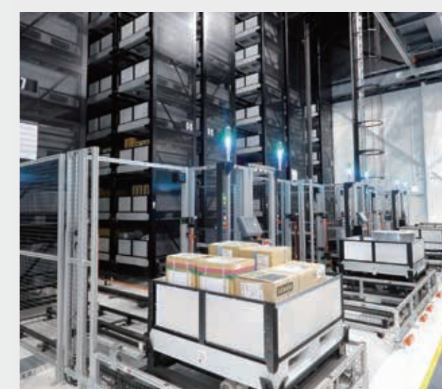
③パレット式自動倉庫 パレットの呼び出しなどの操作はすべて携帯端末で実施。
