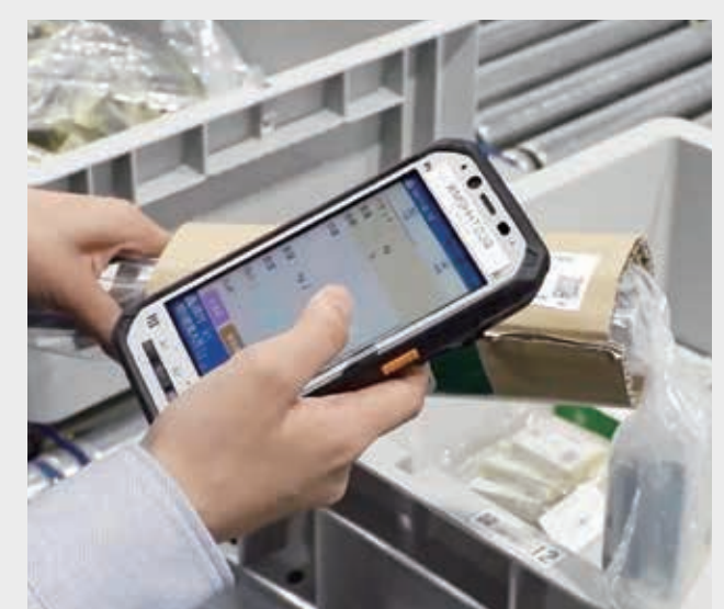
⑨WMS トヨタWMSでパーツの入出荷をトータル管理。出庫時は最適なピッキング経路が携帯端末に提示されるため、慣れないスタッフでも効率的な作業が可能。
