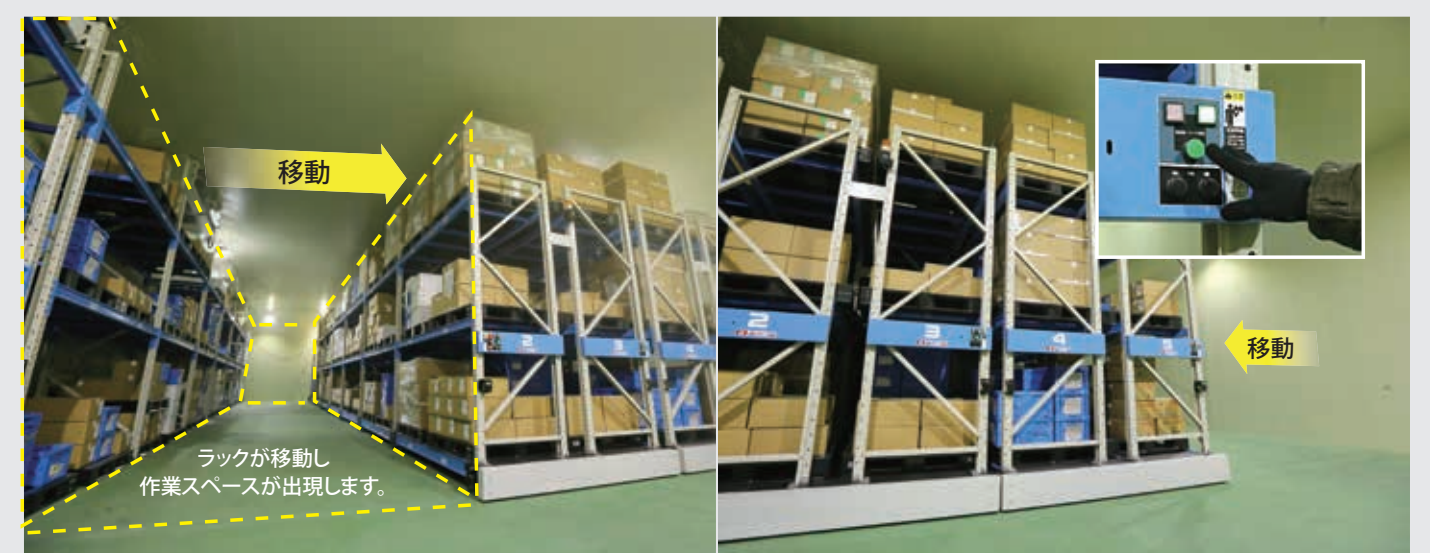
④実質1つの通路スペースで、入出庫が可能になり、冷凍庫内を最大限に活用。ボタンで簡単に操作可能。
