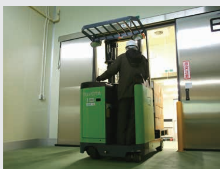
①入出庫作業 トラックヤードから冷凍庫内まで、小回りの効くリーチタイプ電動フォークリフト（冷凍・冷蔵庫仕様）で素早く入出庫作業を行う。
