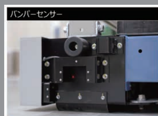
各種センサーなどで異常を検知した場合、全台車が停止。
