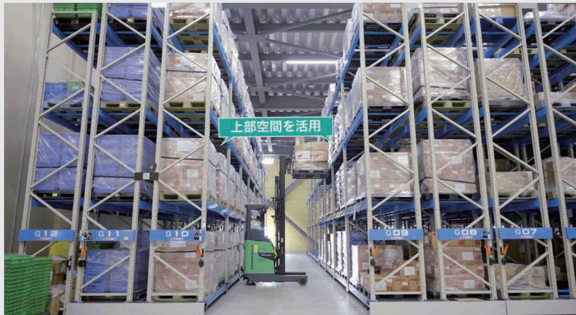
上部空間を有効活用でき、従来の平置き・段積み に比べて保管効率が約175%向上。 荷物の視認性も良くなり、作業効率も向上。
