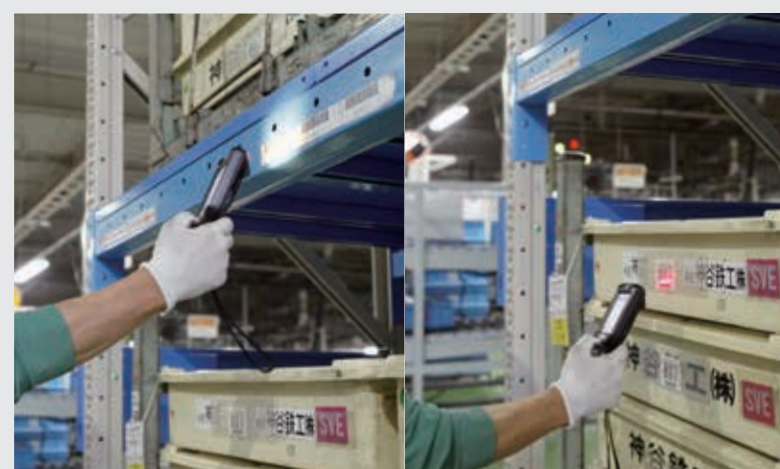
③ 入出庫 ハンディ端末で棚と商品のバーコードを読み取るだけで、簡単に入出庫の管理が可能。
