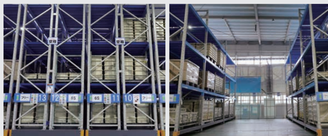
① 保管 移動ラックで、入出庫時の必要な時にのみラックを開閉でき、限られたスペースを有効活用。ラックの開閉は、ボタン1つで簡単に操作可能。
