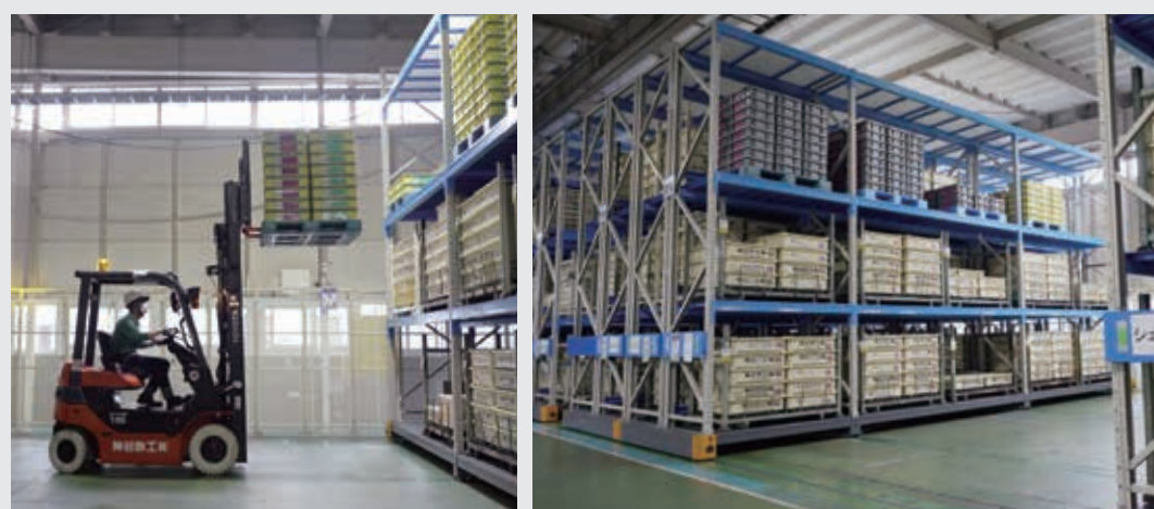
② 保管 上部空間を利用することで、保管効率を最大化。また、平置き保管からラック保管にすることで、荷繰り作業が不要に。
