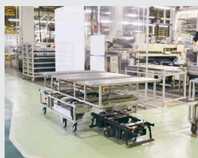
④空走行 移載後、台車をキーカートがAラインに自動搬送。
